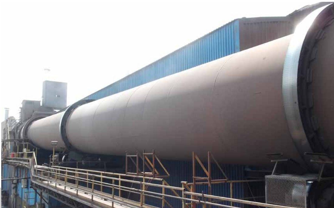
Horno waelz de las instalaciones de Befesa en Iskenderun (Turquía).
