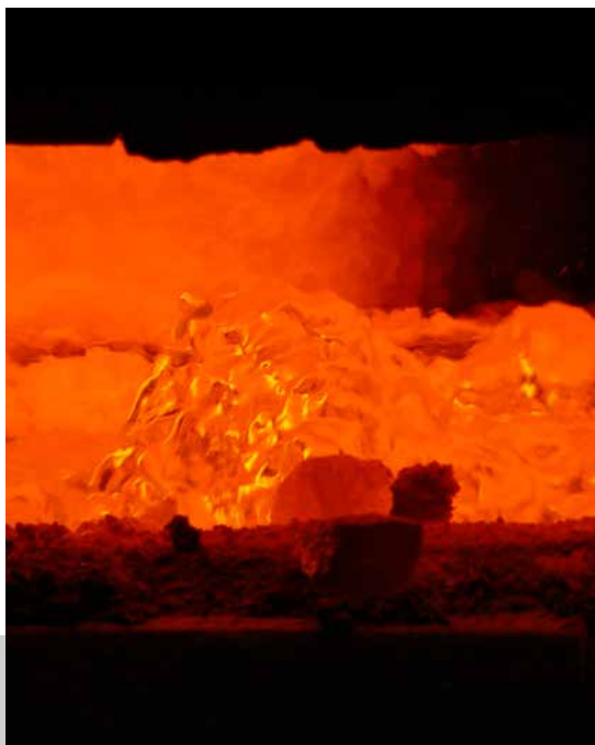
Borboteo de metal líquido durante el reciclaje de aluminio.
