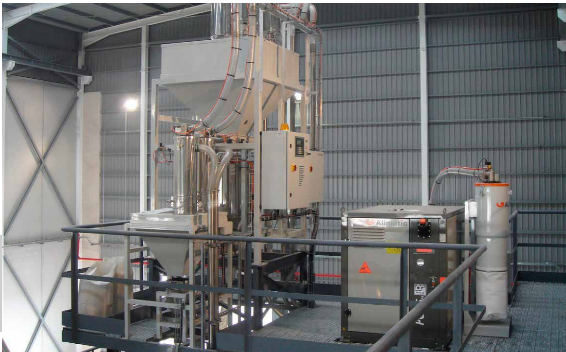
Parte de planta de demostración para el aprovechamiento de residuos de fibra de vidrio como refuerzo en termoplásticos en Alhama de Murcia (España).
