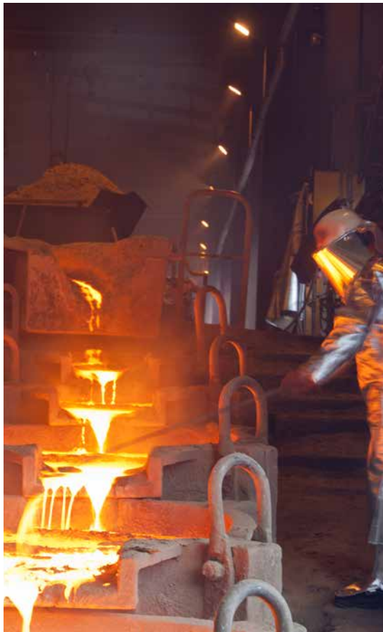
Salida de lingoteo del arrabio aleado en las instalaciones de Befesa Valera en Gravelines (Francia)
