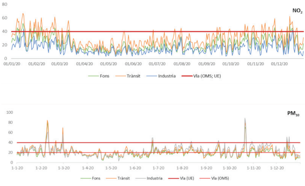
Figura 8. Mitjana dels nivells diaris de contaminació (NO 2 i PM 10 ) registrats als punts de mesurament de la XVPCA ubicats a l'àrea metropolitana de Barcelona segons la seva tipologia (de fons, trànsit i industrials) i valors límit establerts per la UE i recomanats per l'OMS.
