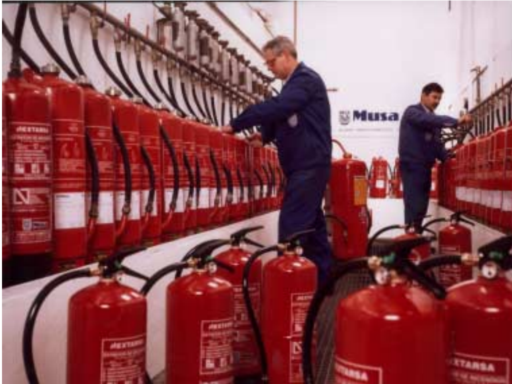
Banco de retimbrado de extintores
