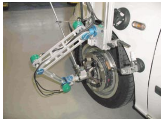
Equip d'assaig, desenvolupat per Applus+ Idiada, per avaluar i millorar la seguretat dels vehicles
