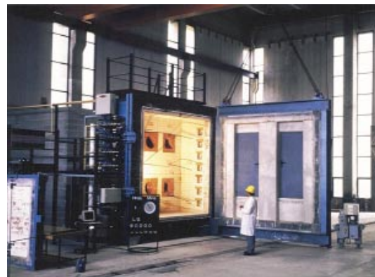
Forn per a la realització d'assajos de resistència al foc d'elements constructius
