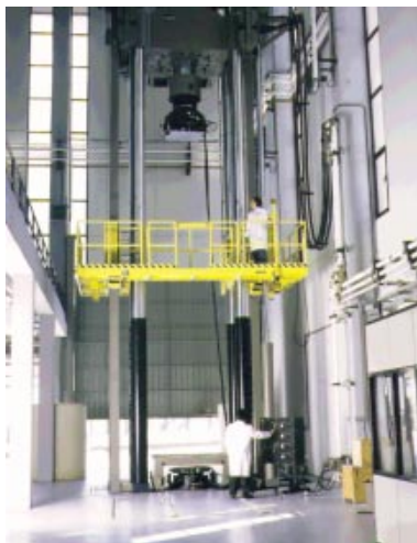
Máquina dinámica para ensayos de tracción-compresión y flexión de grandes estructuras de ingeniería civil
