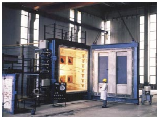
Horno para la realización de ensayos de resistencia al fuego de elementos constructivos
