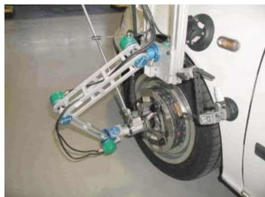
Equipo de ensayo, desarrollado por Applus+ Idiada, utilizado para evaluar y mejorar la seguridad activa de los vehículos
