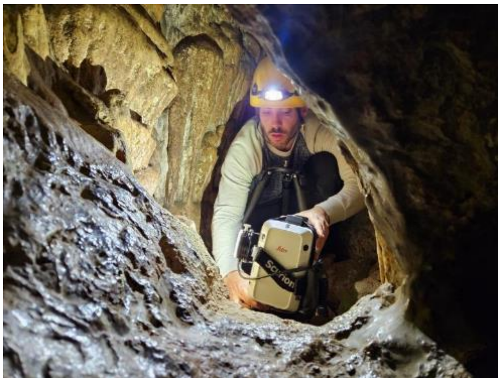
Figura 9.- Exemple del posicionament del escàner làser terrestre Leica RTC360 directament sobre el seu suport per al terra.
