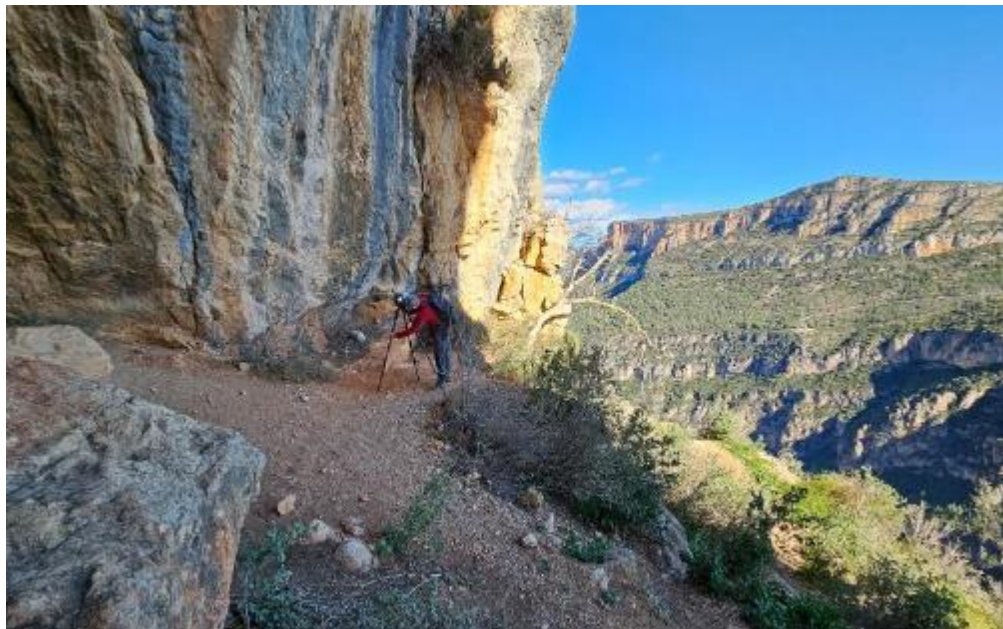
Figura 8. -Exemple del posicionament de l'escàner làser terrestre Leica RTC360 sobre el trípod a l'entrada de la Cova del Tabac.
