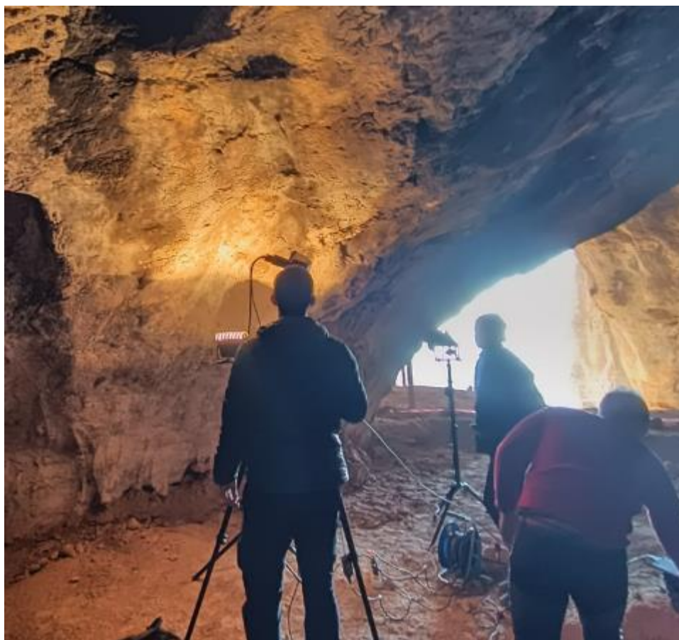
Figura 39.- Escombrat hiperspectral de la pintura aïllada de la cúpula con la càmera VNIR A-Series, de Headwall, i focus halògens de 400W.
