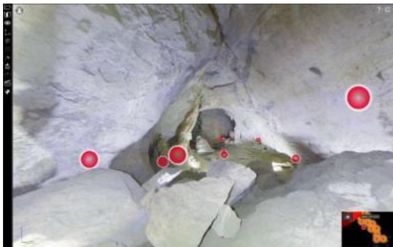
Figura 20.- Vista de la part intermitja de la cavitat de la Cova del Tabac, a la zona de caos de blocs formats per el desplom del sostre, utilitzant el programari d'ús gratuït TrueView . Els cercles vermells indiquen la posició dels escanejats a través dels quals es pot navegar fent click sobre cadascun.
