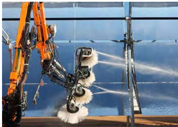
Vehículo de limpieza de colectores cilíndricos parabólicos.
