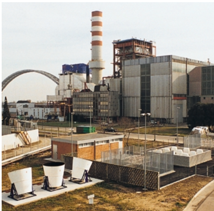
Il sistema SCAI presso la centrale di Fusina (VE): in primo piano a sinistra i sistemi SODAR Doppler per la misura del profilo verticale del vento e, a destra, il RASS per la misura del profilo verticale della temperatura dell'aria
