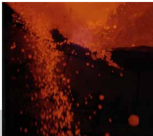
Caída de escoria del horno waelz de Befesa Zinc Aser (España)
