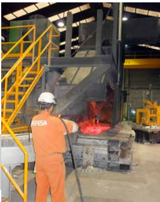
Proceso de desgasificado en las instalaciones de Befesa Aluminio (España)
