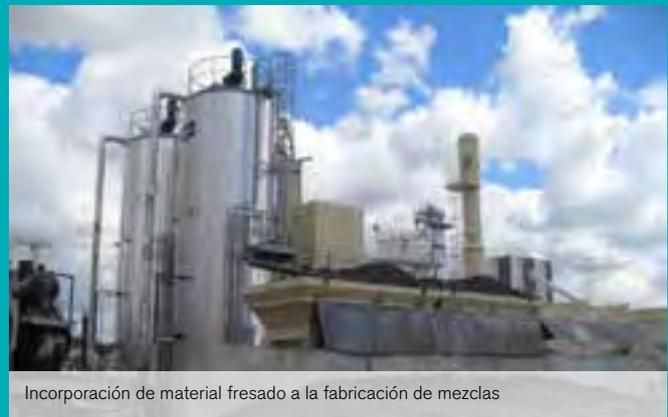
Incorporación de material fresado a la fabricación de mezclas
