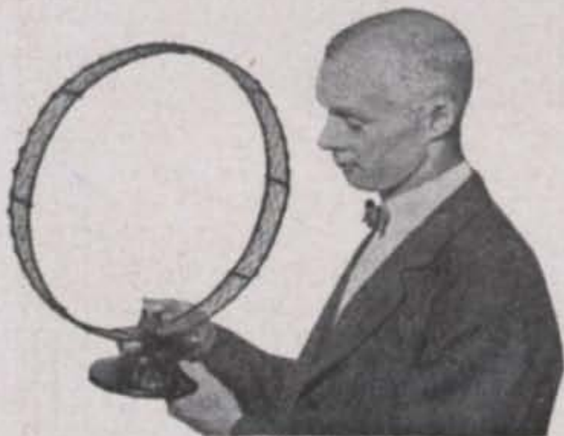
Model d'antena circular; la seva característica, a més d'una bonica presentació, és el lloc reduït que ocupa i la seva facultat d'orientació
