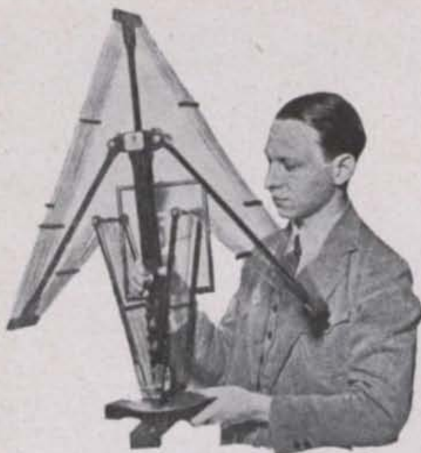
Talment com un paraigua, aquesta antena ofereix l'avantatge de poder portar-la de viatge i ésser instal·lable en pocs moments allà on més convingui
