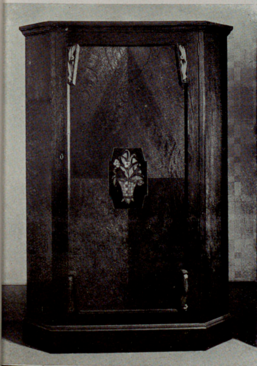
Aplicación de marquetería a la italiana sobre enchapado diagonal en roble cuarteado.
