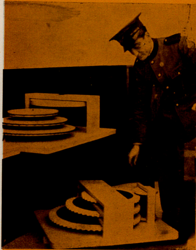
La transmisión de tres velocidades fue inventada por Leonardo 400 años antes del invento del automóvil.
