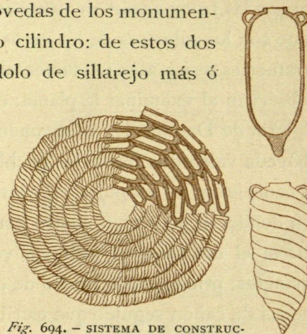
Fig. 694. — SISTEMA DE CONSTRUCCIÓN DE BÓVEDAS POR MEDIO DE ALFARERÍA, USADO EN EL EXARCADO DE RÁVENA, SEGÚN DEMANET ( Cours de Construction ).
