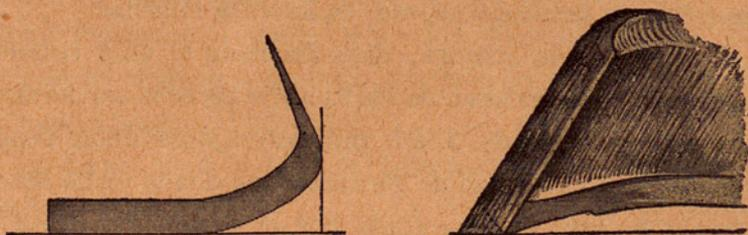
Figs. 43 y 44.—Sección de la herradura según una línea que pasa por mitad de las lumbres mostrando la incurvación, dada por la justura (según Pader).
