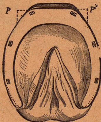
Fig. 73.—Pie posterior provisto de herradura de lumbres torneadas y doble pestaña.
