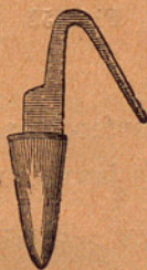
Fig. 251.—Clavo redoblado de Hübner y Pfau.
