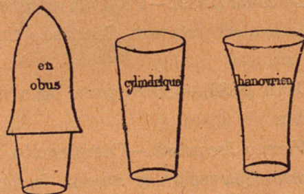
Fig. 238.—Clavijas de Judson (Aureggio).
