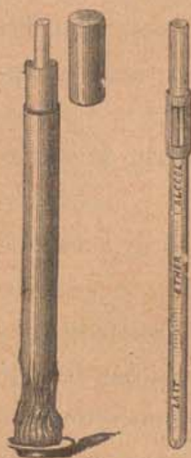
Fig. 57. Lactobutirómetro de Marchand.
