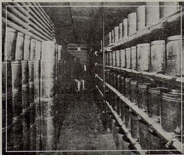
Cámara frigorífica donde se conservan las latas de huevos sin cáscara
