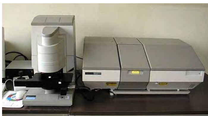
Figura 10. Sistema de adquisición de imagen NIR de mapeo por puntos.
