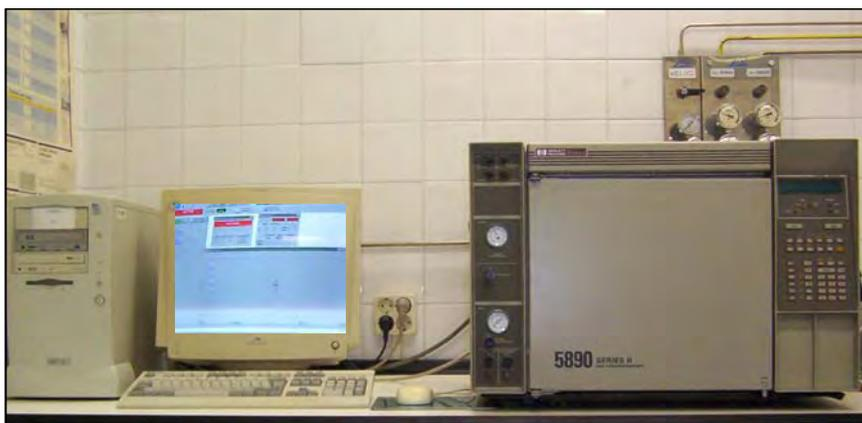
Figura 4.8. Cromatógrafo de gases
