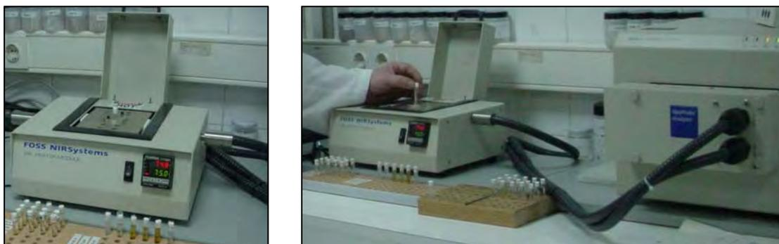
Figura 4.6. Módulo VHM (izq.) y conjunto NIR-VHM (der.)
