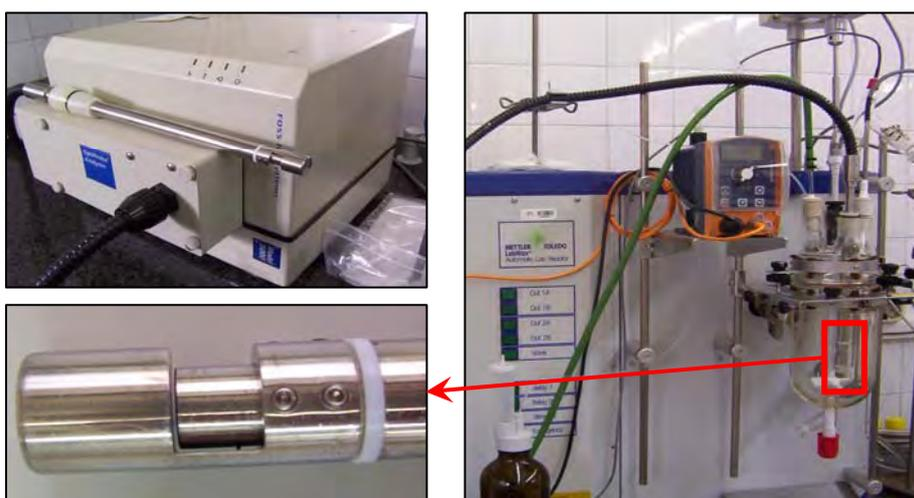
Figura 4.7. Espectrofotómetro NIR con sonda de registro por transflectancia (sup. izq.), reactor LabMax con la sonda de registro (der.) y ampliación del camino óptico (inf. izq.).
