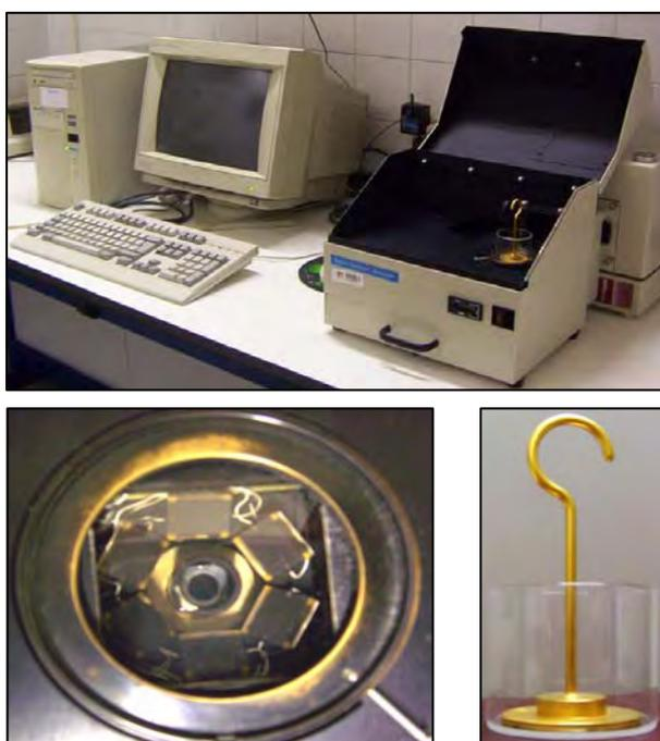
Figura 4.5. Fotografía del modulo RCA (arriba), disposición de los 6 elementos de detección (izq.) y sistema de medida con cubeta de cuarzo y reflector de oro (der.).
