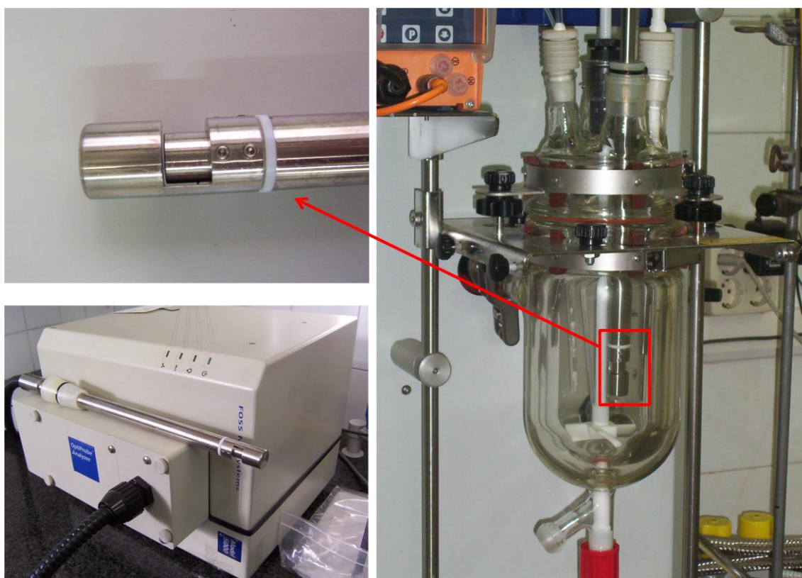
Figura 5.3 Espectrofotómetro NIR con sonda de registro por transflectancia (izq), reactor LabMax con la sonda de registro (der.). Ampliación del camino óptico (sup. izq.).
