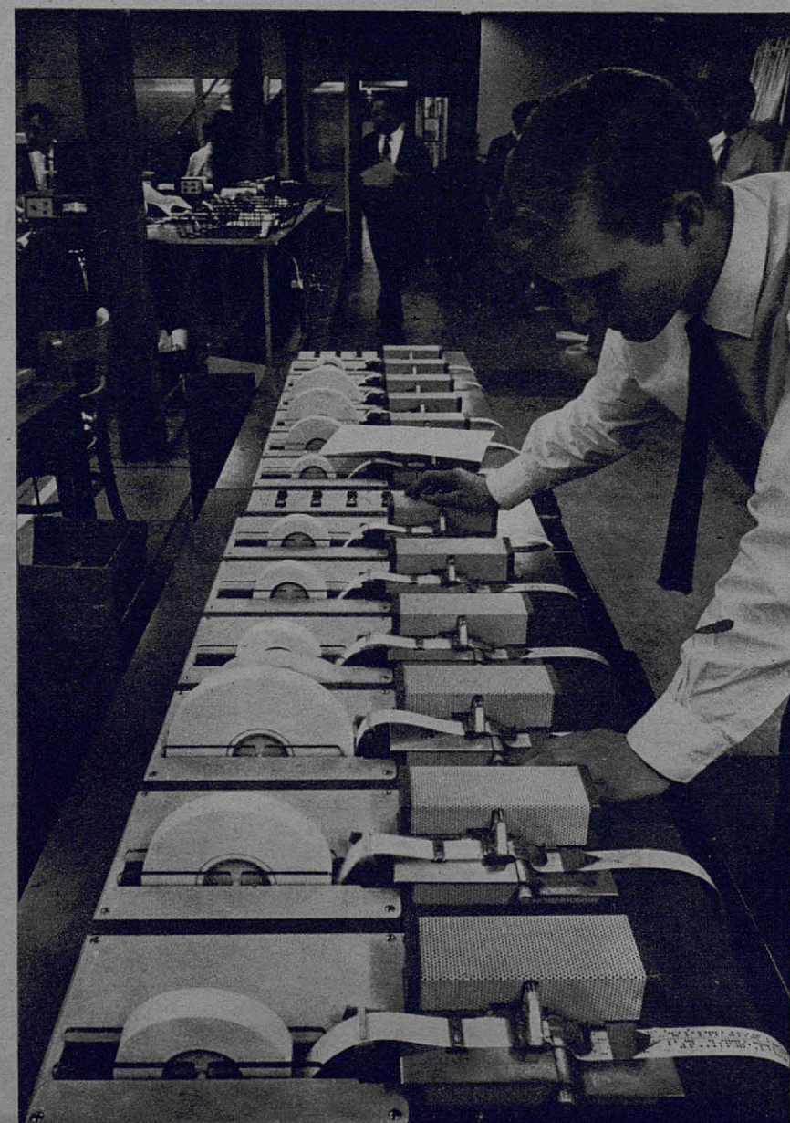
El texto transmitido por la máquina es recogido por un cerebro electrónico —el ordenador «Elliott 308 B» de la fotografía superior— que lo envía a una batería de doce perforadoras que consignan las instrucciones tipográficas.
