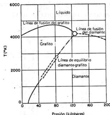
c) ¿Si este diagrama es correcto, a qué temperatura y presión tienen la misma densidad el grafito y el carbono fundido?
