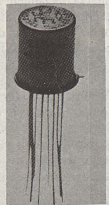
Un relè especialment resistent a vibracions i cops.
