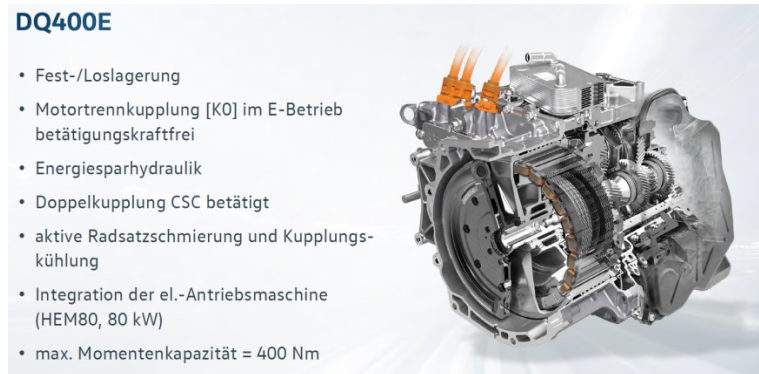
Figura 24. Exemplo de Transmissão "Híbrida" do VW DQ400E
