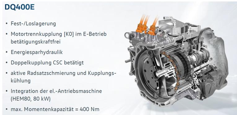
Figura 24. Ejemplo de transmisión "híbrida" VW DQ400E
