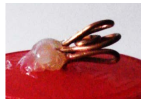
Electroscopis senzills. El de l'esquerra és fet amb fil de soldar d'estany i el de la dreta amb fil de coure gruixut.
