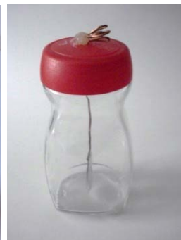
Electroscopis senzills. El de l'esquerra és fet amb fil de soldar d'estany i el de la dreta amb fil de coure gruixut.
