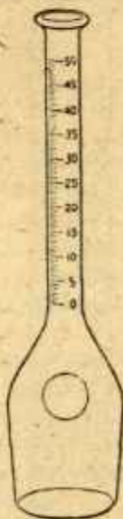
Fig. 17.—Botella para crema de 18 gramos (15,24 centímetros).
