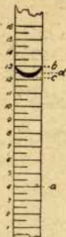
Fig. 23.—Método para la lectura e interpretación de la columna de nata en el análisis de la leche (Léase de a a b y no de a a c ni de a a d ).
