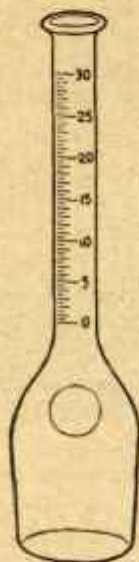
Fig. 16.—Botella para crema de 9 gramos (15,24 centímetros).
