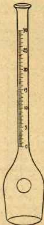
Fig. 18.—Botella para crema de 18 gramos (22,86 centímetros).
