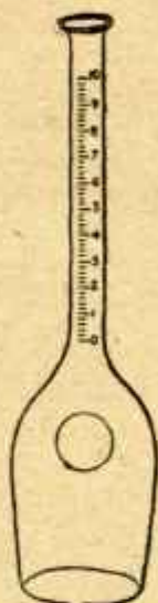
Fig. 1.—Modelo antiguo de la botella de Babcock para el análisis de leche.
