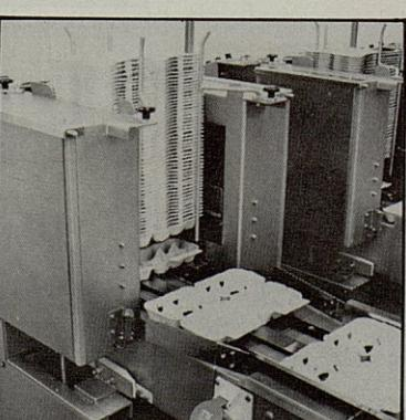
5. Nuevo sistema de desapilado con control electrónico de estuches y cartones que permite una máxima perfección en la operación.
