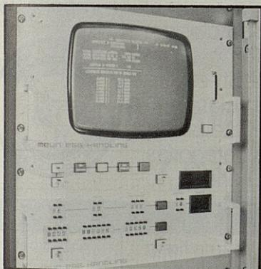
1. Ordenador incorporado, equipado con impresora, para controlar la clasificación, la preparación de pedidos y la producción de las granjas.
