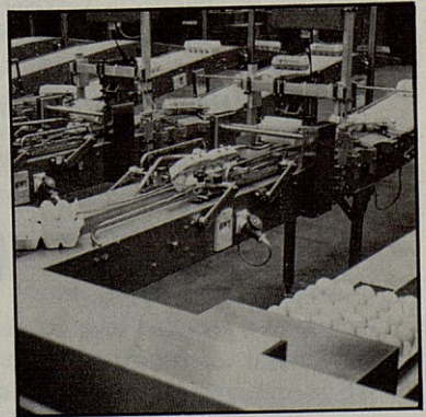
6. Nuevo sistema de cierre longitudinal de los estuches con proceso continuo e impresión de fechas y clases.
