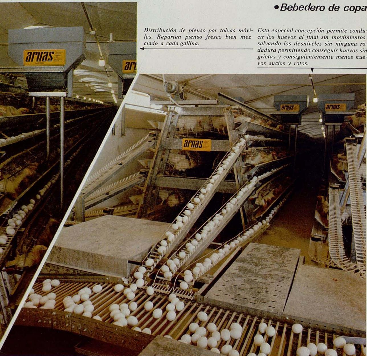
Transportador general de huevos hecho en nylon y fibra de vidrio. Ideal para el transporte desde las baterías al centro de envasado. Cucharillas de plástico insertadas en cadenas, hacen una superficie ideal para transportar y cambiar de nivel los huevos hasta su destino.
