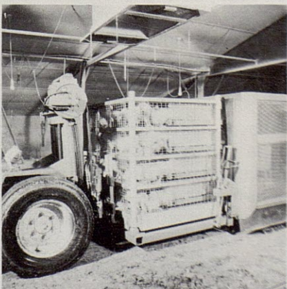
Cuatro aspectos de la máquina recogedora de pollos en funcionamiento: 1) avanzando y cargando; 2) los pollos, en "bandeja", preparados para ser introducidos en las jaulas; 3) el "toro" arrimando éstas vacías; 4) los pollos ya enjaulados.
