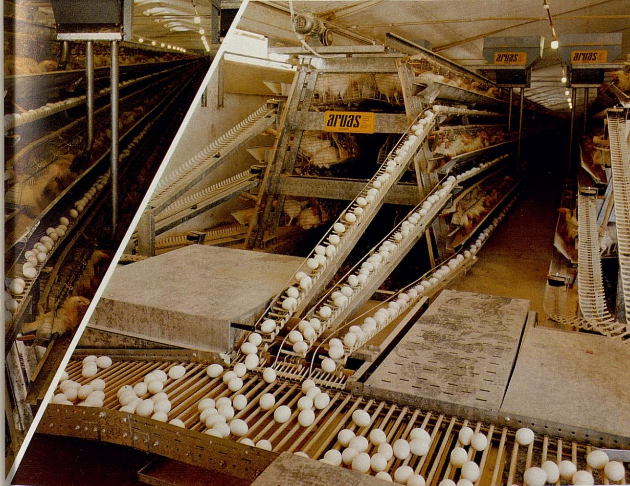
Transportador general de huevos hecho en nylon y fibra de vidrio. Ideal para el transporte desde las baterías al centro de envasado. Varillas de plástico insertadas en cadenas, hacen una superficie ideal para transportar y cambiar de nivel los huevos hasta su destino.
