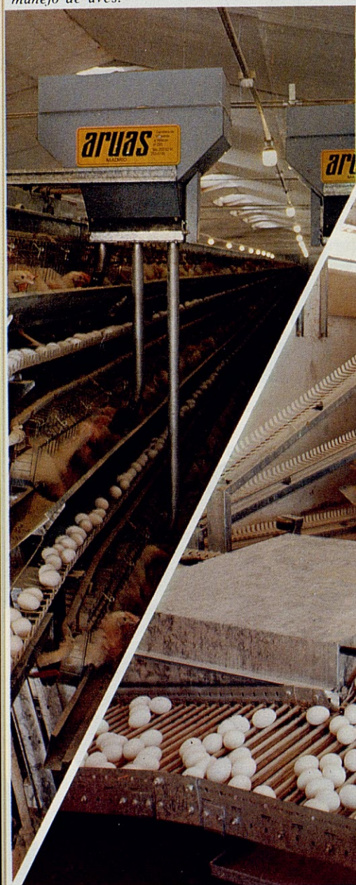
Bebedero de copa muy eficiente, autolimpiante. Todo el frente es puerta, que facilita el manejo de aves.
