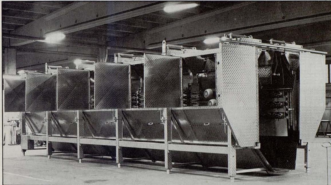
El Tren de Desplumado LINCO es modular -módulos compactos ajustables- y polivalente, puesto que permite la fácil sustitución de cualquiera de sus hileras, según el tipo de ave que se procese -broilers, pavos, etc. Su naturaleza compacta y cerrada permite mantener la temperatura del ave.
