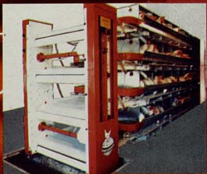
Equipo de accionamiento de una batería para ponedoras con limpieza automática por cinta. Las jaulas FARMER-AUTOMATIC se suministran de 2 a 6 pisos incluyendo sistemas automáticos para la alimentación, bebida, recolección de huevos y limpieza.
