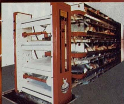
Equipo de accionamiento de una batería para ponedoras con limpieza automática por cinta. Las jaulas FARMER-AUTOMATIC se suministran de 2 a 6 pisos incluyendo sistemas automáticos para la alimentación, bebida, recolección de huevos y limpieza.
