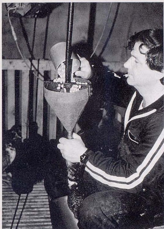
Operación de carga de la máquina embuchadora mientras se ejecuta el embuchado del maíz cocido.
