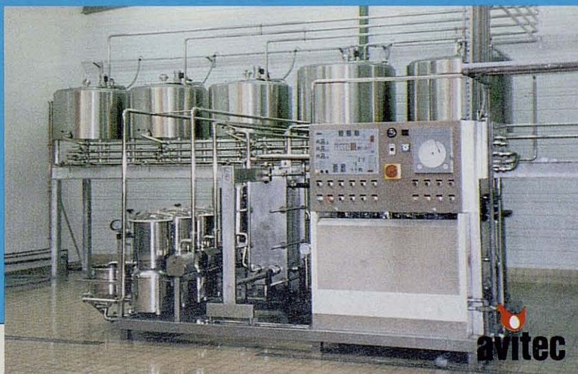
Planta de pasteurización AVITEC para huevo entero, yema y clara, de 750 l/h equivalentes a 15.000 huevos/hora
