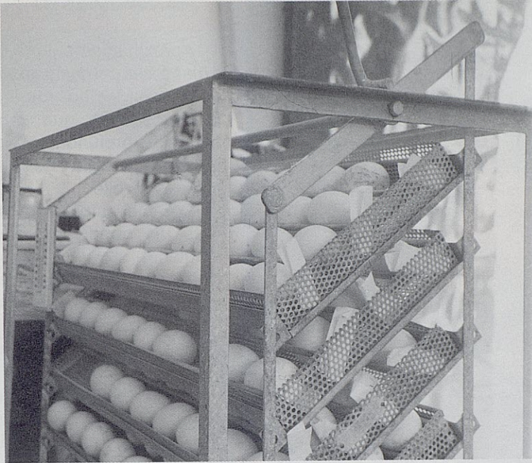
Carro volteador para la conservación de huevos.
