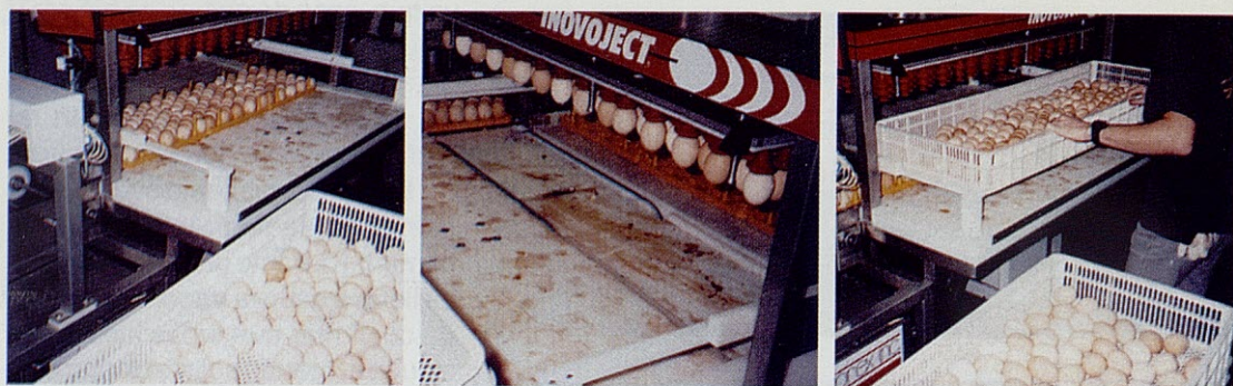
A continuación de la inyección los huevos se transfieren de las bandejas de carga a las de las nacedoras.
