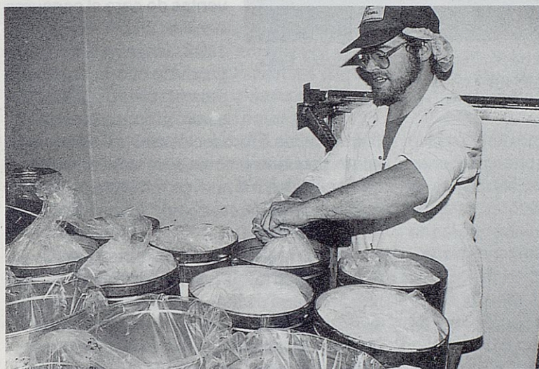
Acondicionamiento de ovoproductos en sacos de plástico en el interior de bidones metálicos.
