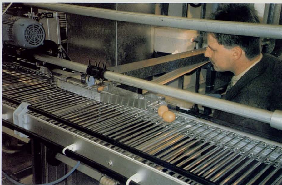
Detalle de la batería italiana FACCO, con un contador de huevos incorporado al transportador de huevos, para poder registrar los recogidos por cada una de las cintas.
