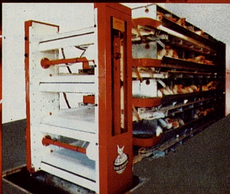
Equipo de accionamiento de una batería para ponedoras con limpieza automática por cinta. Las jaulas FARMER-AUTOMATIC se suministran de 2 a 6 pisos incluyendo sistemas automáticos para la alimentación, bebida, recolección de huevos y limpieza.
