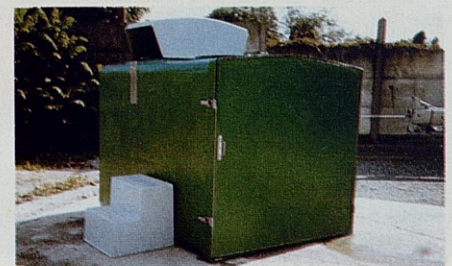
Cajón isotérmico para refrigeración y almacenamiento de los cadáveres.
