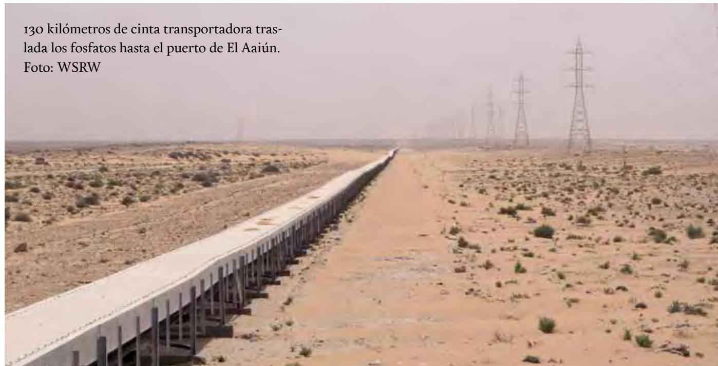
130 kilómetros de cinta transportadora traslada los fosfatos hasta el puerto de El Aaiún.
