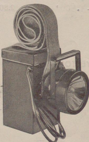
Compuesta de faro de latón pintado negro y óptica plateada con portálámparas enfocable de bayoneta 15 mm. dos enganches un polo, provisto de asa, interruptor, lámpara, cáncamo para sujeción en la caja o en la bandolera y caja de chapa de hierro negra con bandolera, con capacidad para el alojamiento de dos elementos batería feroníquel.
