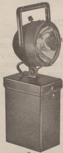
Compuesta de faro de latón pintado negro y óptica plateada con portálámparas enfocable de rosca mignonet un polo, provisto de asa; interruptor, lámpara y adosado a una caja de chapa de hierro negra con capacidad para el alojamiento de dos elementos batería feroníquel.
