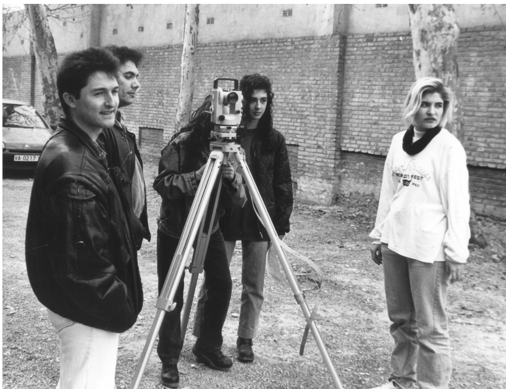
Fig. 2.- Utilización del teodolito: la lectura de cotas estratigráficas
