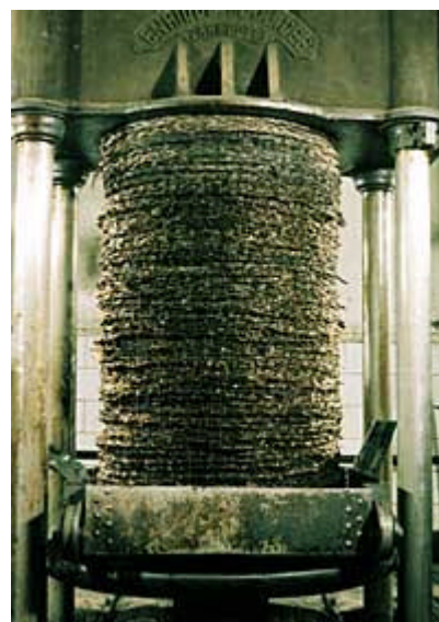
Figura C.2 Premsa d'oli tradicional, on entre els cofins d'espart s'intercala pasta d'olives.
