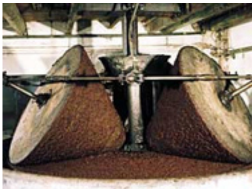
Figura C.1 Molturació de les olives mitjançant molí de pedra. És una variant del mètode tradicional que encara és força extesa.
