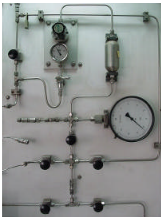
Figura 115: dreta i dalt, línies de gasos utilitzades en els experiments d'hydroformilació. El reservori es carrega a una determinada pressió amb CO i H 2 en una relació del 50%.
