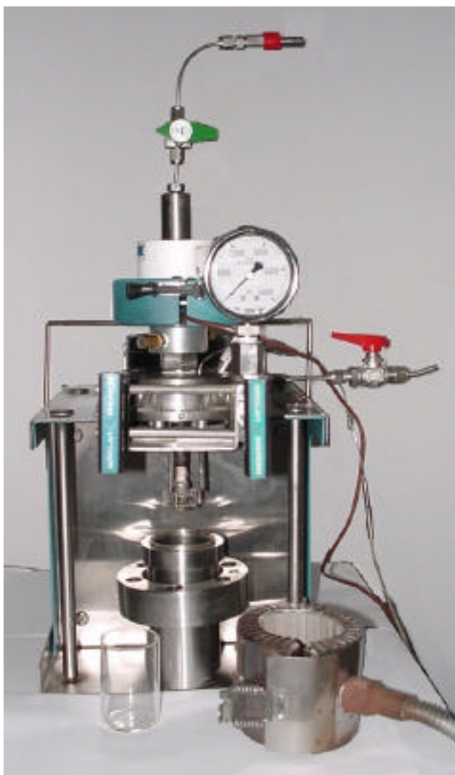
Figura 113: Esquerra, fotografia del reactor utilitzat en tots els experiments d'hidroformilació (Autoclave Engineers). Dalt, fotografia del controlador d'agitació i temperatura del reactor.
