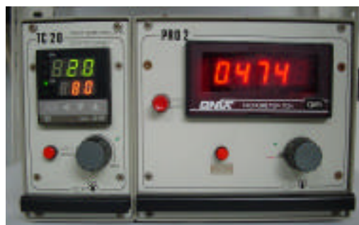
Figura 113: Esquerra, fotografia del reactor utilitzat en tots els experiments d'hidroformilació (Autoclave Engineers). Dalt, fotografia del controlador d'agitació i temperatura del reactor.
